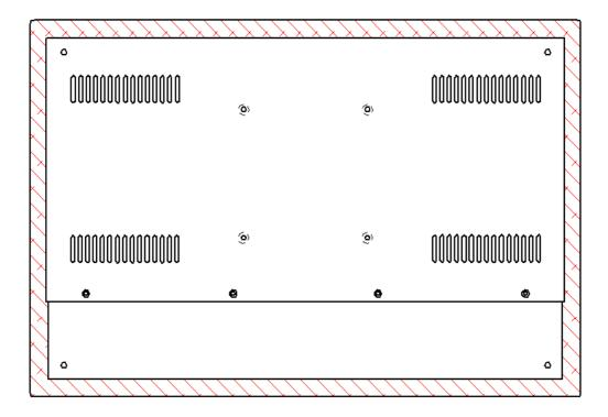
Durch Aufbringen einer Zellkautschukdichtung (Stärke 2mm) im rückseitigen Randbereich des Panels (rot schraffiert) kann nach DIN EN 60529 eine Schutzart IP65 bzw. NEMA 12 zum Schaltschrank hin erreicht werden.
